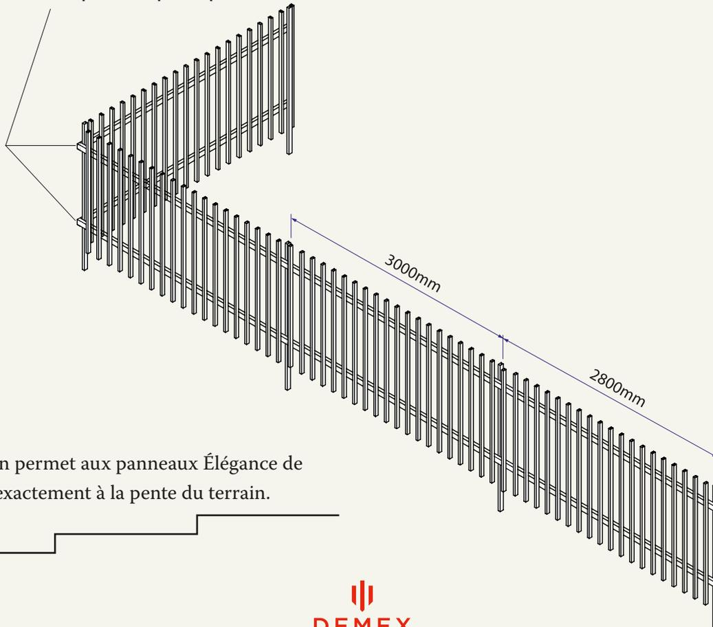
Une option permet aux panneaux Éléance de s'adapter exactement à la pente du terrain.
